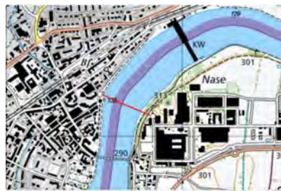
Variante 1: Brückenlänge ca. 300 m, Höhenunterschied ca. 11.5 m
